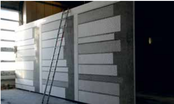
Støbning af elementer med mønster i ‘grafisk beton’, Confac, Randers
