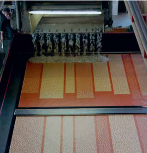
Støbning af elementer med mønster i ‘grafisk beton’, Confac, Randers
